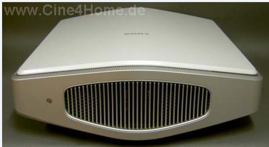
Die enormen Luftschlitze an der Rückseite lassen auf die erforderliche Luftmenge zur Kühlung schließen
