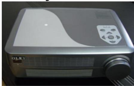
Hersteller Oley bietet mit dem MP 640E einen LCD Projektor mit VGA 640 x 480 Auflösung und einem Kontrast von 500:1 an. Die Lampenlebensdauer wird mit 6000 Stunden angegeben vom Hersteller, was umgerechnet über 8.2 Jahre bei 2 Stunden täglich wären. 1200 Ansi-Lumen sorgen dafür, dass auch eine Bildbreite von 302 cm möglich ist. Wenn Raumlicht vorhanden ist, dann sollte das Bild jedoch max. 201 cm breit sein. Er wird jetzt nicht mehr vom Hersteller Oley angeboten.
