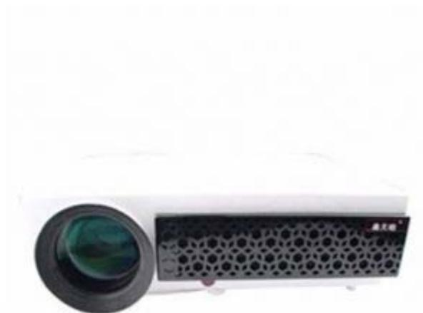
Das Htp Modell LED-96+ ist ein LCD LED Projektor mit WXGA 1280 x 800 Auflösung und einem Kontrast von 2000:1. Eine LED Lebensdauer von 20000 Stunden gibt der Hersteller an, was bei einem täglichen schauen von 4 Stunden über 13.7 Jahre wären.
